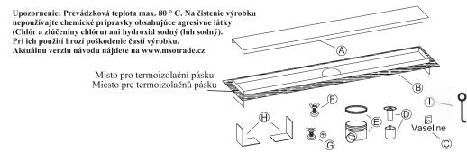
Součástí balení je nástroj pro vytahování a čištění sifonu. (I) Súčasťou balenia je nástroj pre vyťahovanie a čistenie sifónu. (I)
